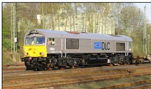
Bild 1: Diesellokomotive vom Typ „JT42CWR“ (Class66), die sehr häufig im grenzüberschreitenden Schienengüterverkehr eingesetzt wird
