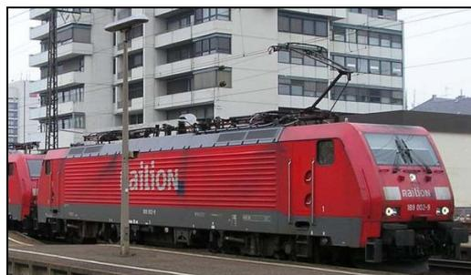
Bild 2: Elektrolokomotive vom Typ ES64 F4 als Baureihe 189 mit Vier-Stromsystem-Ausstattung für den schweren grenzüberschreitenden Schienengüterverkehr
